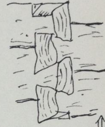
ikinci kat duvarlarının inşaa şekli (Kırlongış kuyruğu bağlantısı)
