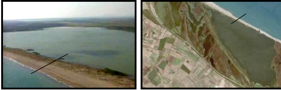
Foto 16. Deltanın KD'sunda bulunan Liman gölünün 1990'lı yılların başına ait havadan görünümü (güneye bakış). Aynı yeri (göl ile Karadeniz arasındaki kıyı okunun) 2005 yılına ait uydu görüntüsü (Kaynak: Google Earth). Kıyıda görülen erozyonun etkisi nedeniyle göl ile deniz arasında bulunan kum seti tamamen ortadan kalkmak üzere.
