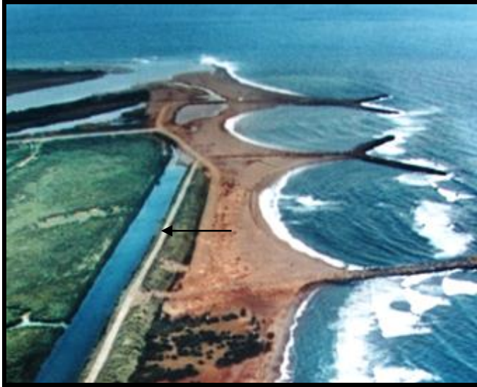
Foto 10. 1990'lı yılların başlarında Kızılırmak nehrinin Karadeniz'e döküldüğü ağız kısmı ve sol. alt köşede DSİ tarafından yapılan Kuşaklama Kanalı. Ok'la gösterilen kısım yaklaşık 400 m olup, 10 yılda aşınmıştır. (Fotoğraf 1990'lı yılların başlarında uçaktan çekilmiş bir video görüntüsünden elde edilmiştir).
