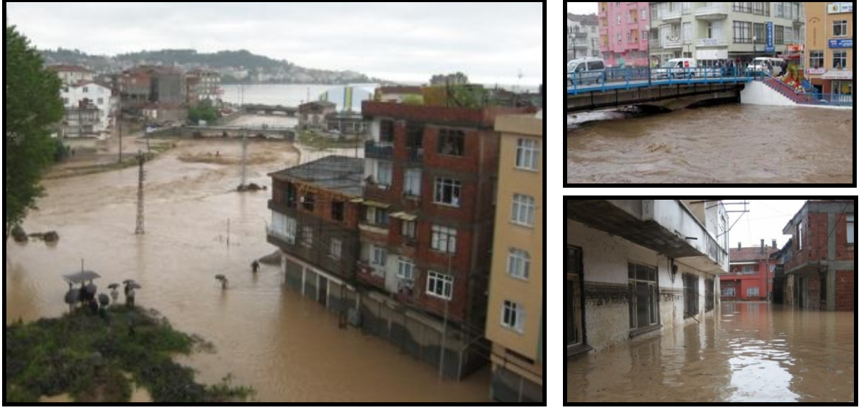
Foto 4. Aşırı yağışlar, ırmak boylarının yerleşmeye açılması sonucu daraltılmış yatağına sığmayan sel suları ve kıyıda yer alan alçak köprülerin tıkanarak küçük birer baraja dönüşmesi gibi nedenler sonucu 6.7.2006'da yaşanan ve büyük zararlara sebep olan Ünye sel felaketinden görüntüler (Kaynak: İHA ve DHA).
