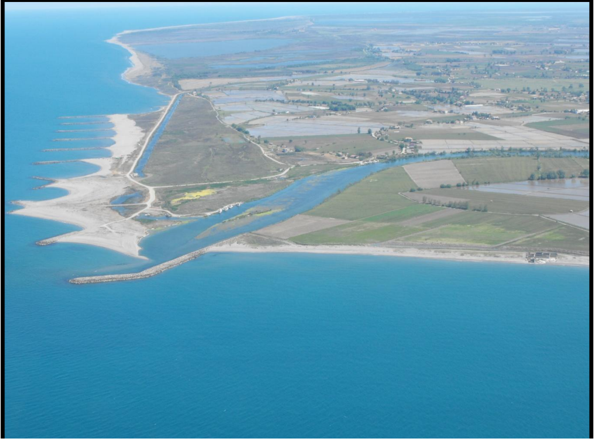
Foto 6. Kızılırmak Deltası kuzey ucunda gerilemeyi durdurmak amacıyla inşa edilmiş mahmuzlar.
