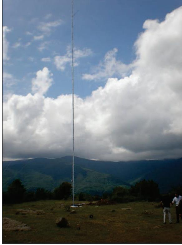
Foto 2. Dedebuzağı Tepesi üzerinde rüzgâr hızı, 60 m yüksekliğinde boru tipli bir ölçüm direği yardımıyla ölçülmüştür.
