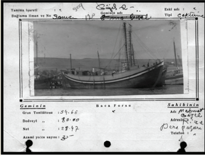
Foto 7. Ceylan isimli yük motorunun fotoğrafı ve başlıca teknik özelliklerini gösteren karteksin ön ve arka yüzü.
