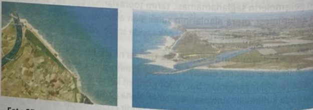
Foto 27-28. Delta'nın kuzeyinde gerilemeyi önlemek için yapılan mahmuzlar.
