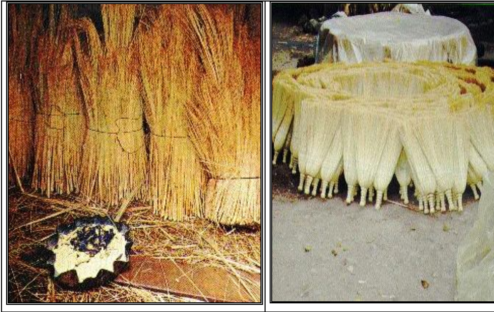
Foto 9: Süpürgenin daha parlak ve sarı bir görünüm kazanması için üstleri örtülerek ya da kapalı bir odada depolanarak kükürtlenmesi işlemi
