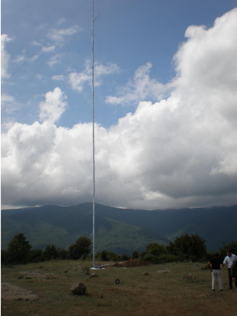
Foto 3. Dedebuzağı Tepesi üzerinde rüzgâr hızı 60 m yüksekliğinde boru tipli bir ölçüm direği yardımıyla ölçülmüştür.
