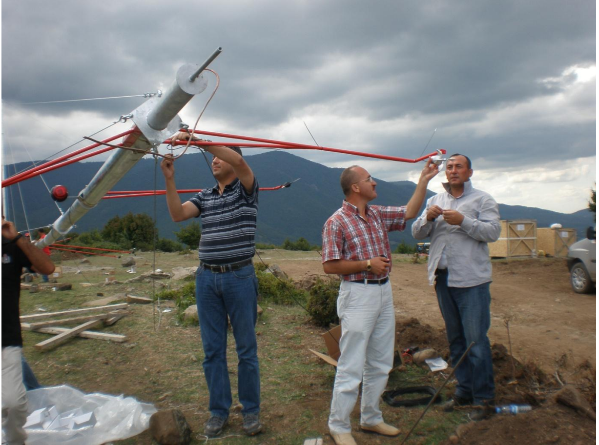
Foto 2. İnceleme alanında rüzgâr potansiyelini belirlemek amacıyla kullanılacak ölçüm direğine, dikilmeden önce anemometre ve yön sensörleri monte edilmiştir.
