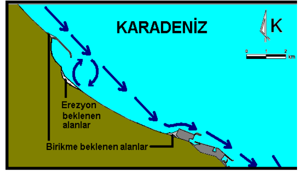
Şekil 3. Sanat yapılarının tamamlanmasından sonra oluşacak yeni kıyı akıntı düzeni.
