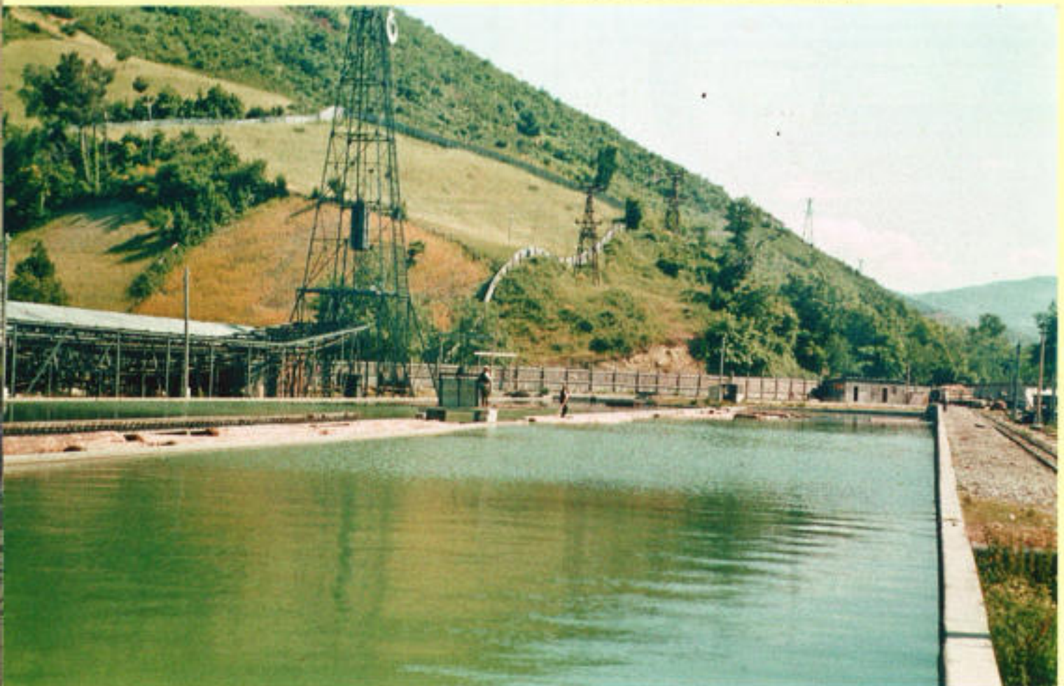
Abb. 129 Im Sägewerk erreicht man zuerst die Klotzschanlage. Hier werden Eisenbahn- und Seilbahnwagen entladen und im Klotzsch zur Weiterverarbeitung vorbereitet.
