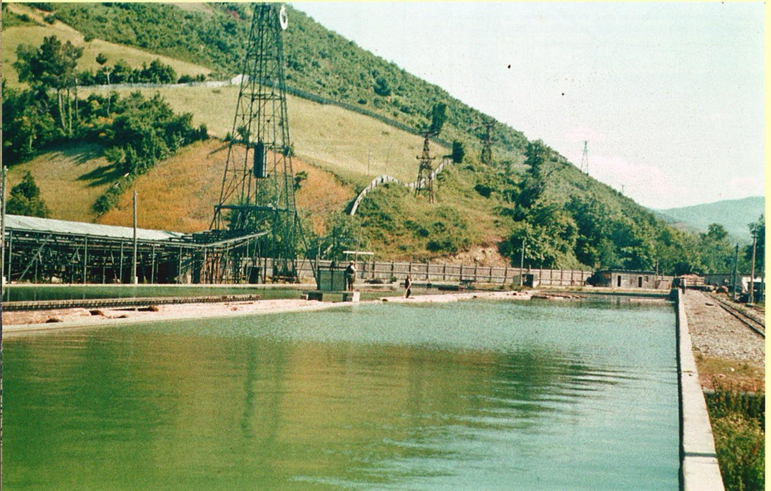
Abb. 128 Im Sägewerk erreicht man zuerst die Klotzteichanlage. Hier werden Eisenbahn- und Seilbahnwagen entladen und im Klotzteich zur Weiterverarbeitung vorbereitet.
