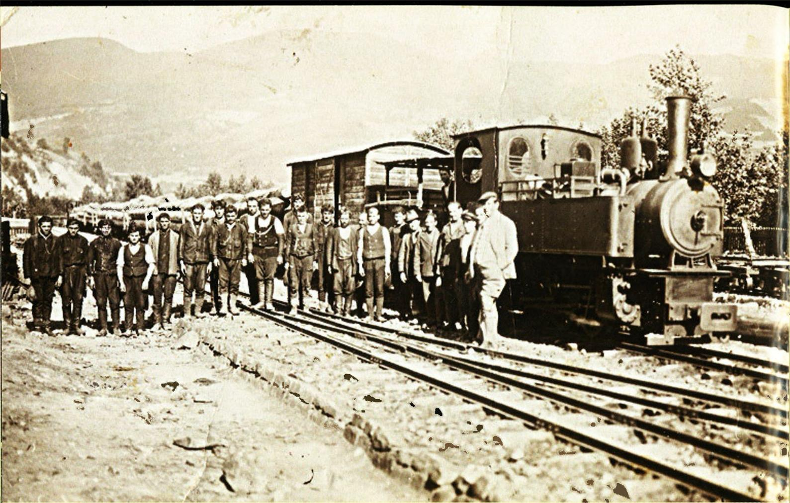
Abb. 120 Die Zugmannschaft posiert stolz vor ihrem Produktionszug. Zuglok ist eine der O+K C-Kuppler, dann der Tender, ein gedeckter Güterwagen, mindestens 10 Paar Langholztrucks und schließlich eine weitere Lokomotive als Schublok.
